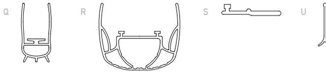
Joint en matière thermoplastique ignifuge mono-extrudé.
