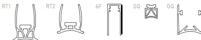
Joint en silicone ignifuge (classe UL94-V0 au feu).
