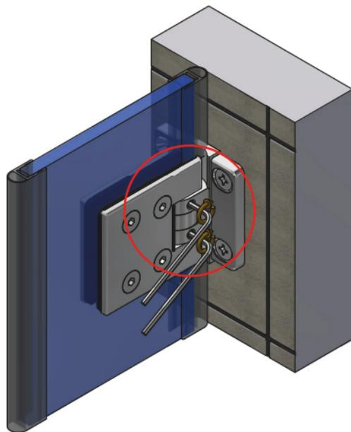
Wenn der Türflügel ausgerichtet ist und alle Dichtprofile aufgesteckt wurden, kann die Nulllage eingestellt werden. Dabei sind die Gewindestifte wechselweise auf das angegebene Drehmoment anzuziehen und nach ca. 15 Minuten nachzuziehen.
