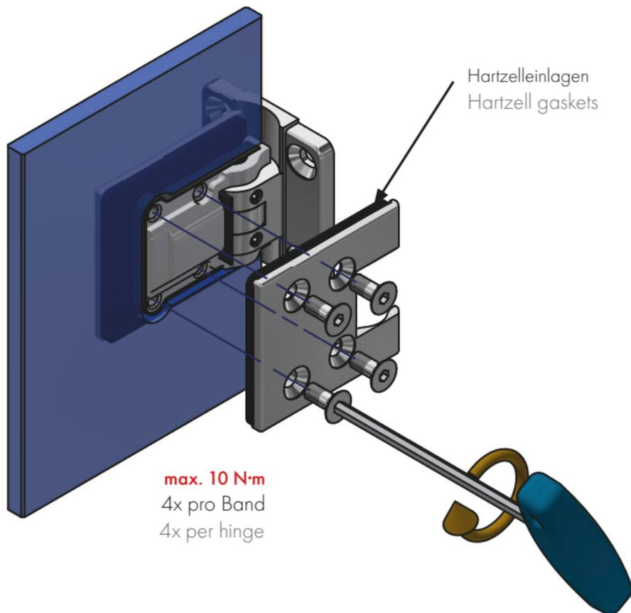
Das Gehäuse des Duschtürbandes mittig im Glasausschnitt positionieren, um den grösstmöglichen Verstellbereich für die Einstellung der Dusche zu gewährleisten. Die Schrauben sind wechselweise bis zum Erreichen des max. Anzugsmomentes von 10N·m anzuziehen. Nach ca. 15 Minuten noch einmal wechselseitig auf das max. Anzugsmoment nachziehen.
