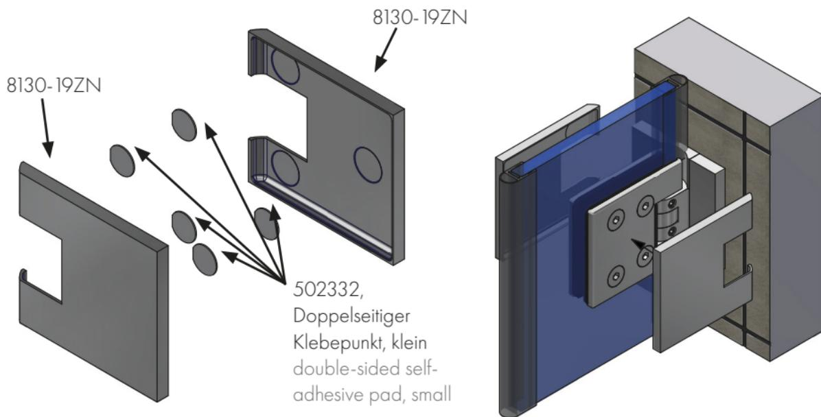
Die Abdeckkappen 8130-19ZN werden ebenfalls mit Klebepunkten Best.-Nr. 502332 am Duschtürband fixiert. Diese kleben Sie bitte vor dem Aufsetzen der Kappe 8130-19ZN in die dafür vorgesehenen Vertiefungen.
