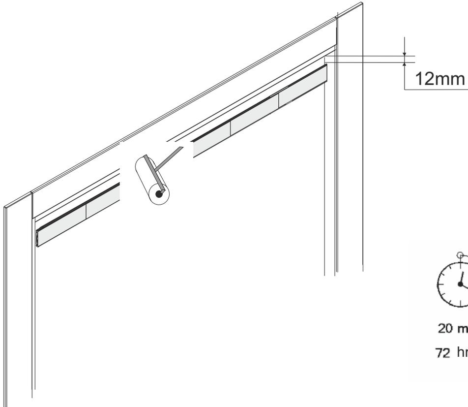
Si raccomanda di lasciare trascorre il tempo massimo di applicazione prima di effettuare il montaggio dell'attuatore.
