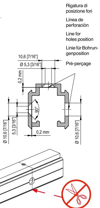
**Evitare di accorciare la barra in prossimità dei fori - No acorte la barra cerca de los agujeros. - Avoid to make the bar shorter near the holes - Die Schiene in der Nähe der Bohrungen nicht abkürzen - Éviter de raccourcir la barre à proximité des trous**
